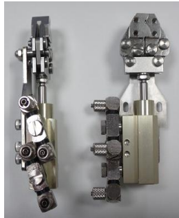
B 電線搬送チャック
