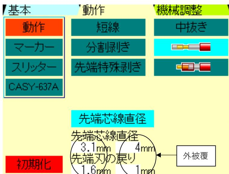
この画面の場合、先端芯線直径は3. 1 mm、刃の戻りは1. 6 mm で、外被覆の直径は4 mm、刃の戻りは1 mm の設定となります。
