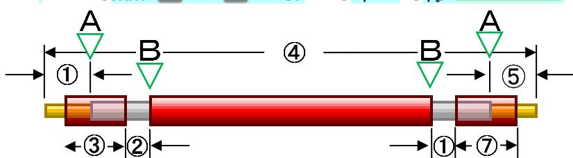
①《先端ストリップ長》：先端側被覆の剥ぎ取り長を設定します。
