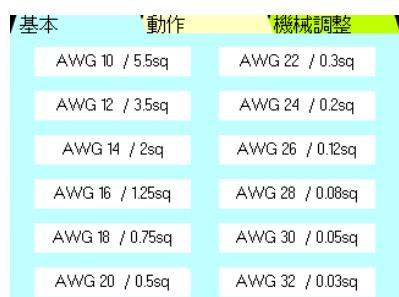
左の画面で電線サイズを選択すると、《芯線直径》と《刃の戻り》にその目安となる数値が自動で入力されます。
