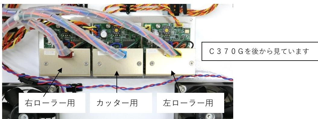
MDU 基板を本体から取り外す際は、MDU5860 基板の穴(2 力所)奥の M3 キャップスクリューを緩めるだけで取り外せます。(下写真矢印の穴)
