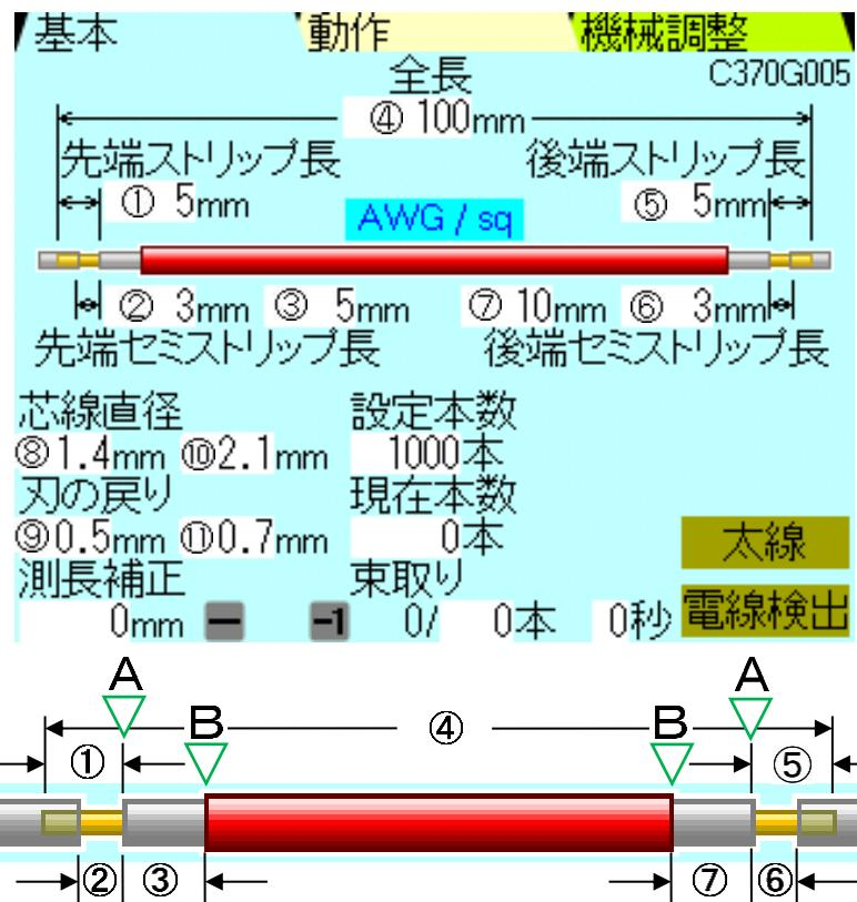
① 《先端ストリップ長》: 先端側被覆の剥ぎ取り長を設定します。
