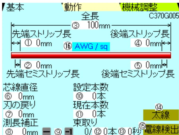
① 《先端ストリップ長》：先端側被覆の剥ぎ取り長を設定します。
