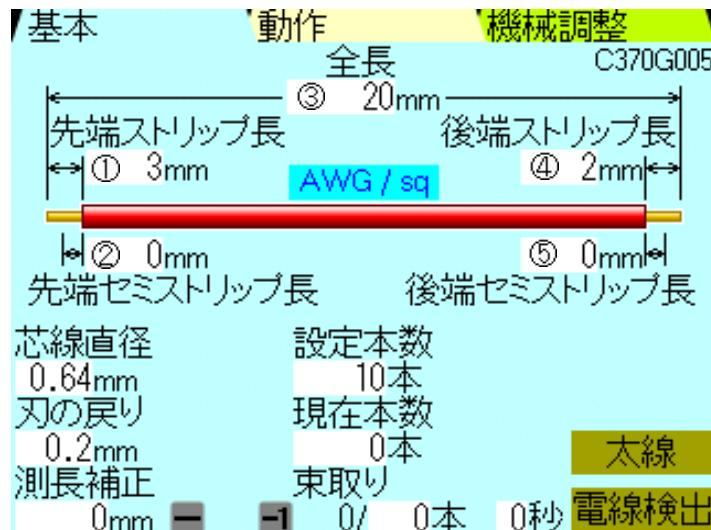
**ワンポイント**：芯線と被覆の固着が強いと設定通りの加工ができない場合もあります。また、短線加工ではセミストリップ加工は出来ますがご希望のセミストリップ状態とは異なる場合があります。加工された線材を基準にして設定を柔軟に変更して下さい。
